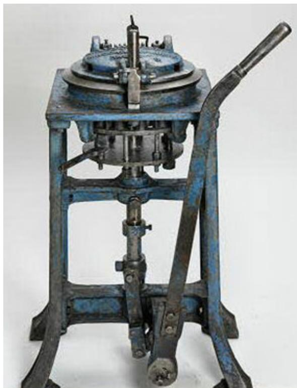
Abb. 20, Teigteilmaschine von Kaufmann & Krüger, Halle a. S., um 1920
