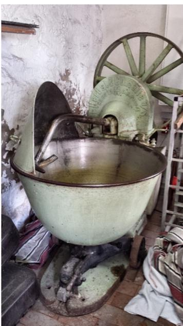
Abb. 4, Drehhebelknetmaschine von F. Herbst & Co. in einem Nebengelass der Bäckerei Mundt, Weißenfels, um 1995
