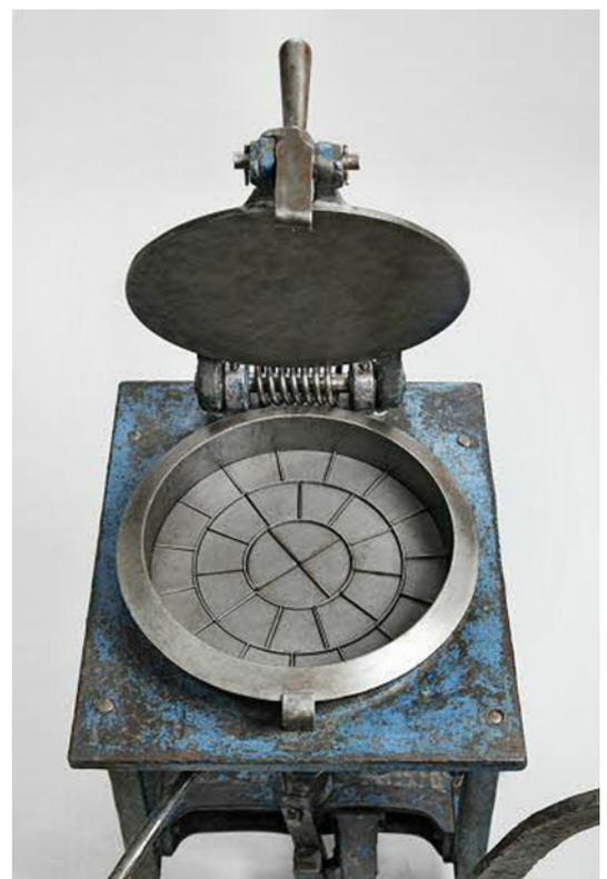
Abb. 12, Teigteilmaschine mit versenkbaren Messern von Kaufmann & Krüger, Halle a. S. um 1920
