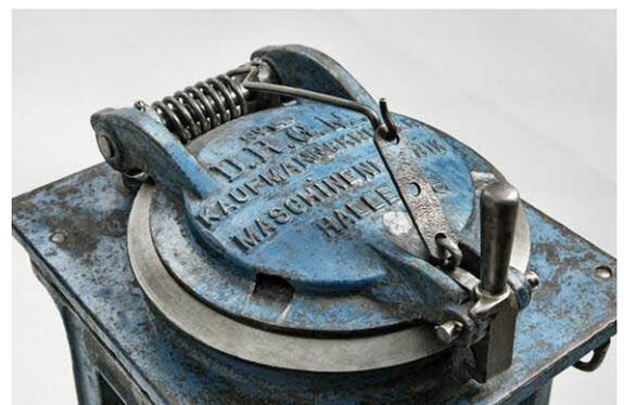
Abb. 5, Teigteilmaschine von Kaufmann & Krüger, Halle a. S. um 1920
